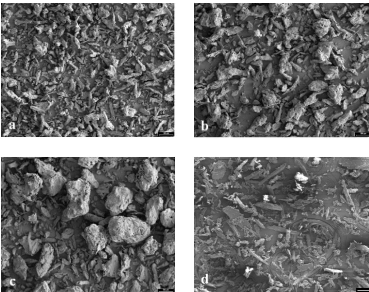
**Figure 4a-d** SEM images of Avicel<sup>®</sup> PH101 (a), PH102 (b), PH200 (c) and paracetamol (d) with 100x magnification (bar length 100µm).
